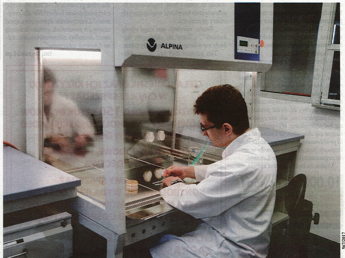
▲ Badania określające obecność mikroorganizmów w próbkach osadów ściekowych przeprowadzane są w komorze laminarnej. To dość długotrwały proces, gdyż ostateczne wyniki uzyskiwane są po upływie dwóch tygodni.
