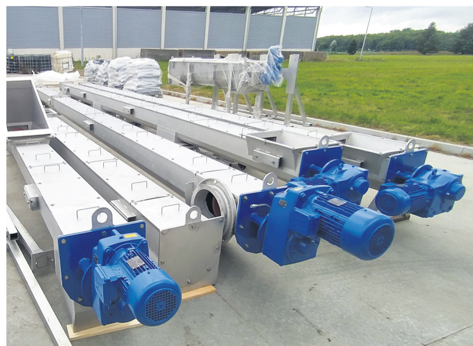
Elementy systemu przenośników spiralnych do transportu odwodnionego osadu ściekowego.
