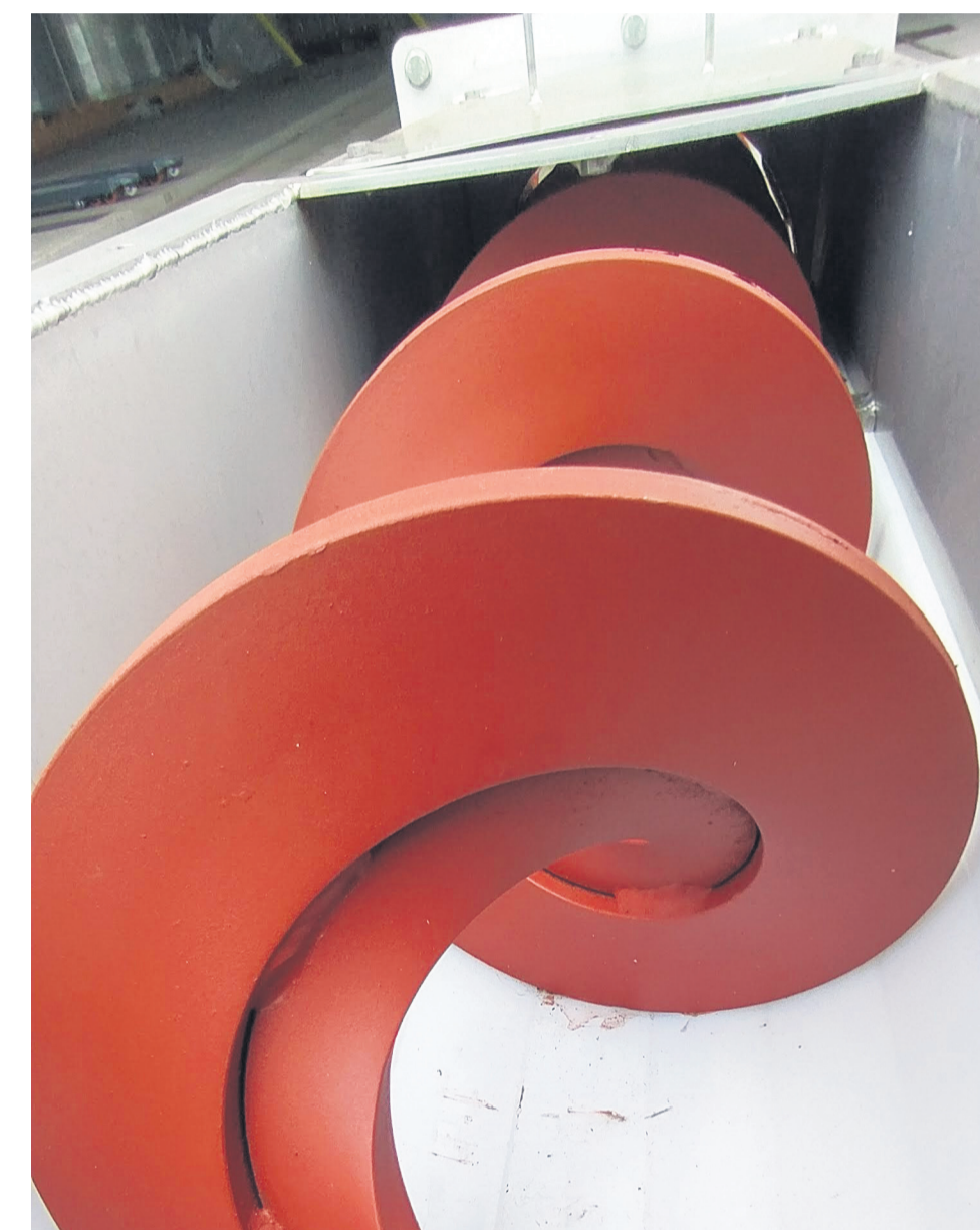
Spirala bezwałowa - najważniejszy element przenośnika do osadu ściekowego.
